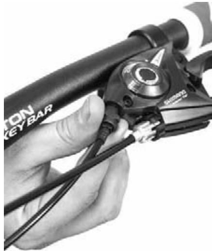
*рисунок 24. регулировка натяжения тросиков переключателей производится таким же образом, как и регулировка тросиков тормозов*
