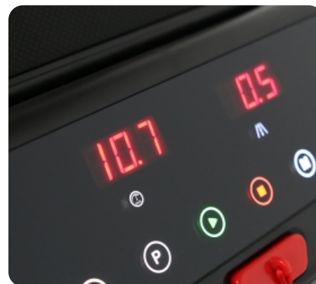
Консоль с 4 буквенно-цифровыми LED-дисплеями и сенсорными кнопками управления
